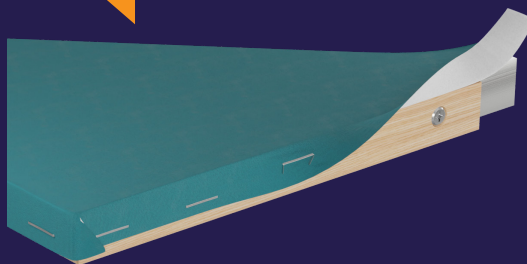
Крепление на алюминиевый профиль деревянной основы для натягивания баннера
